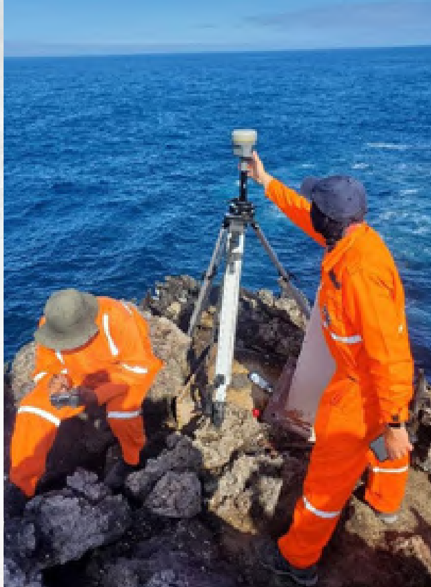
Figura 2. Trabajos Geodésicos en las islas Galápagos como parte del mantenimiento y actualización de las Líneas de Base de los Espacios Marítimos Jurisdiccionales Insulares en los proyectos SUTPLA.
